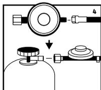
**ETAPE 4** Poser le régleur de pression (30 mbar) sur la bouteille de gaz (10,5 kg recharge maximum). Utiliser pour cela une clé plate réglable. Serrer manuellement n'est pas suffisant et peut provoquer des fuites qui peuvent être très dangereuses. Remplacer la bouteille de gaz seulement dans un endroit bien aéré et hors de portée de bougies, cigarettes et autres sources d'inflammation.
