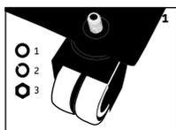
**ETAPE 1** Placer les roues si désirées. L'ordre du montage exact à partir de la base est: boulon – roue – Marino – anneau – ressort – écrou. Utiliser la clé plate jointe pour serrer.
